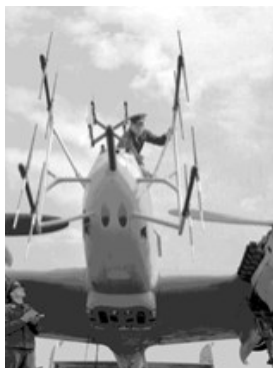
Antenas Yagis para radar del avión. Messerschmitt 110 alemán FuG 220 de la Segunda Guerra Mundial.
