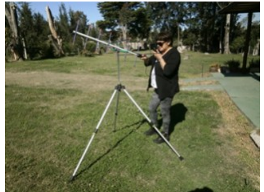
Antena Yagi para seguimiento de satélites
