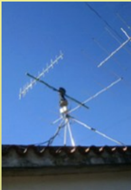
Antenas Yagi para VHF y UHF seguimiento de satélites.
